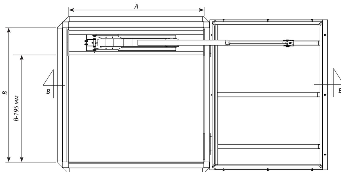
Вид сверху люк дымоудаления типов C/E с одним приводом, размеры в [мм]
