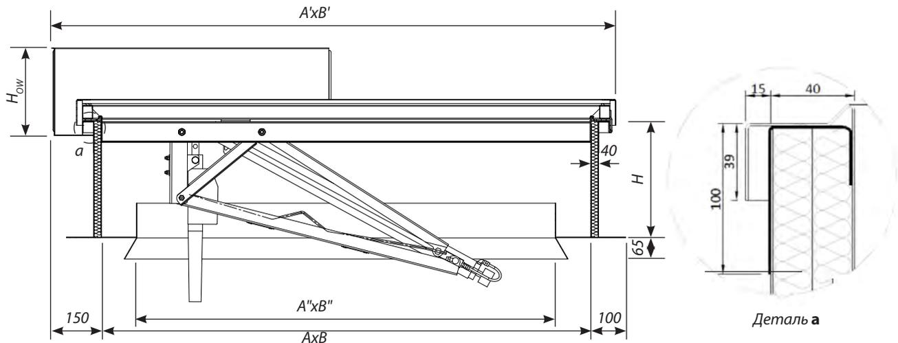
Люк дымоудаления типов C/E в разрезе В-В в закрытом положении, размеры в [мм]
