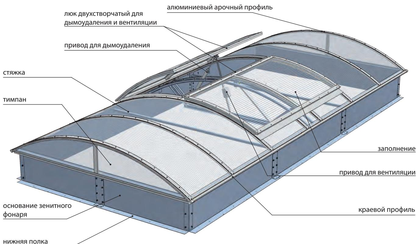
*Конструкция арочной световой полосы с двухстворчатым люком, оснащенный пневмоприводом для дымоудаления и электроприводом для вентиляции*
