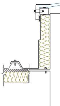
Монтаж люка с основанием PR, сечение перпендикулярно наклону кровли
