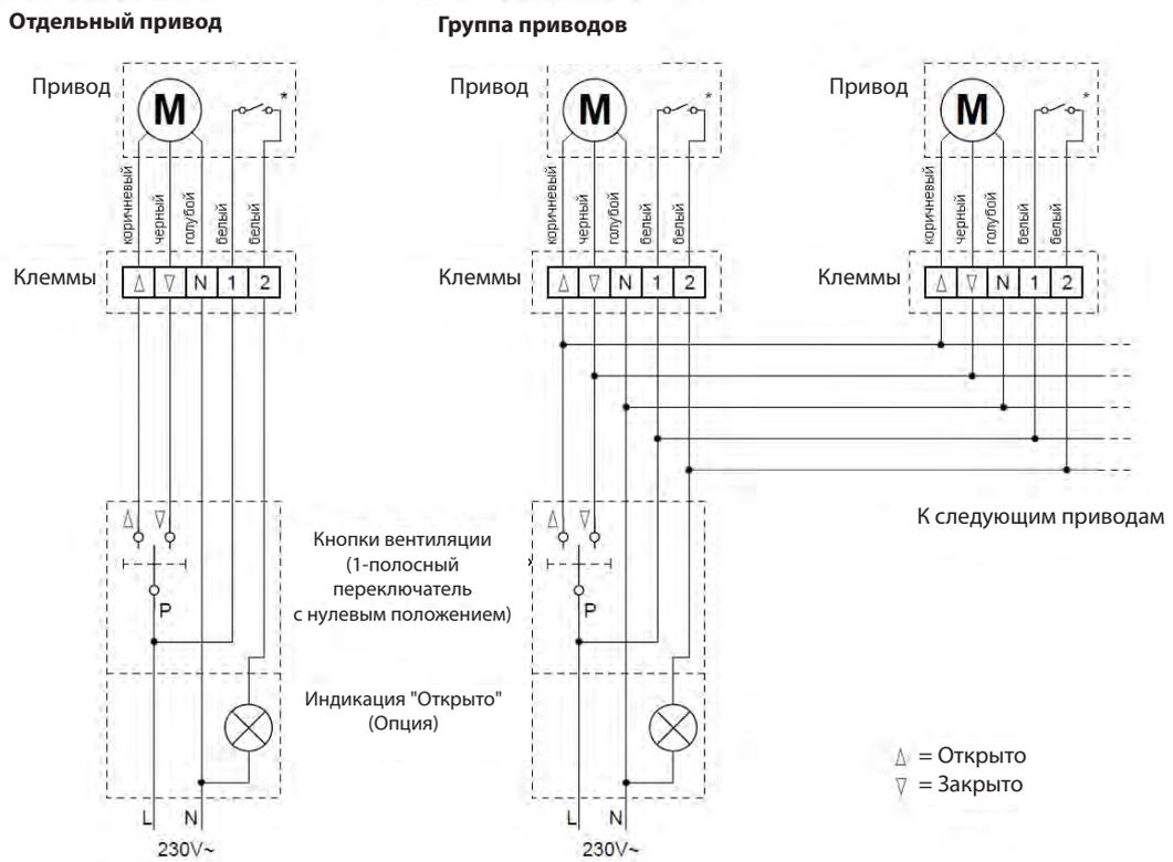
**5.1.16.** Управление вентиляционными приводами 230V~ - система с погодной автоматикой
