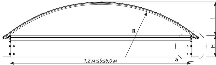
Поперечное сечение А-А световой полосы с арочным сводом
