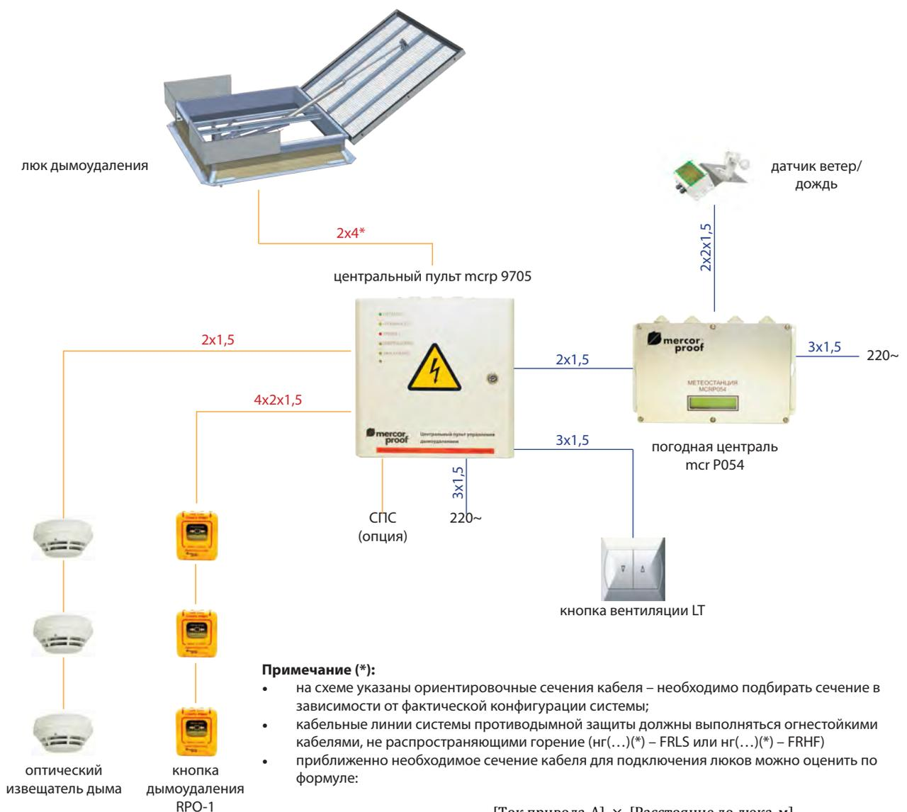
$$[\text{Сечение, мм}^2] = \frac{[\text{Ток привода, А}] \times [\text{Расстояние до люка, м}]}{80}$$
