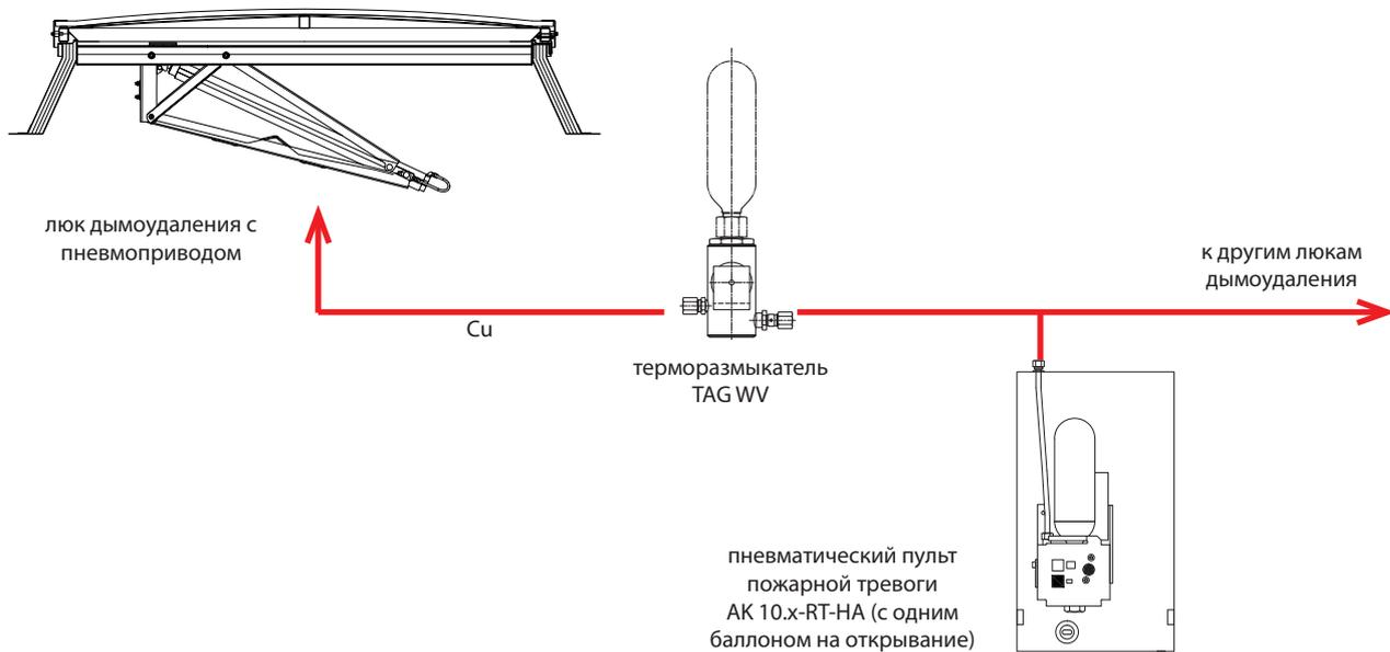
**Пневматическая система управления люками для дымоудаления с автоматическим открыванием от терморазмыкателей и дистанционным (ручным) открыванием и закрытием с пневматического пульта пожарной тревоги\***
