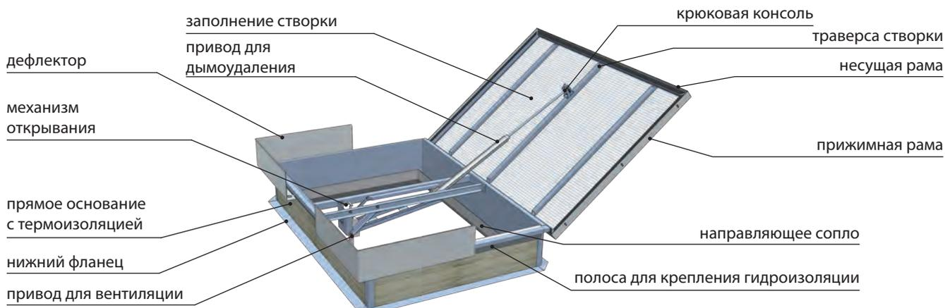
Конструкция люка дымоудаления типов C/E с дефлекторами и направляющим соплом,
