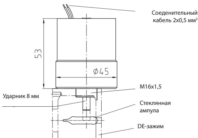
Электромагнитный пускатель ТМ позволяет дистанционно запускать срабатывание терморазмыкательного механизма и тем самым открывать люк дымоудаления, путем разбивания ампулы встроенным ударником, который срабатывает от электрического NO/NC сигнала 24В=3,5 Вт (опционально 12В= и 48 В=).
