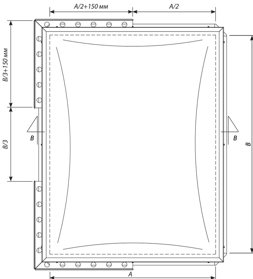
Вид сверху, люк дымоудаления типов C/E, размеры в [мм]
