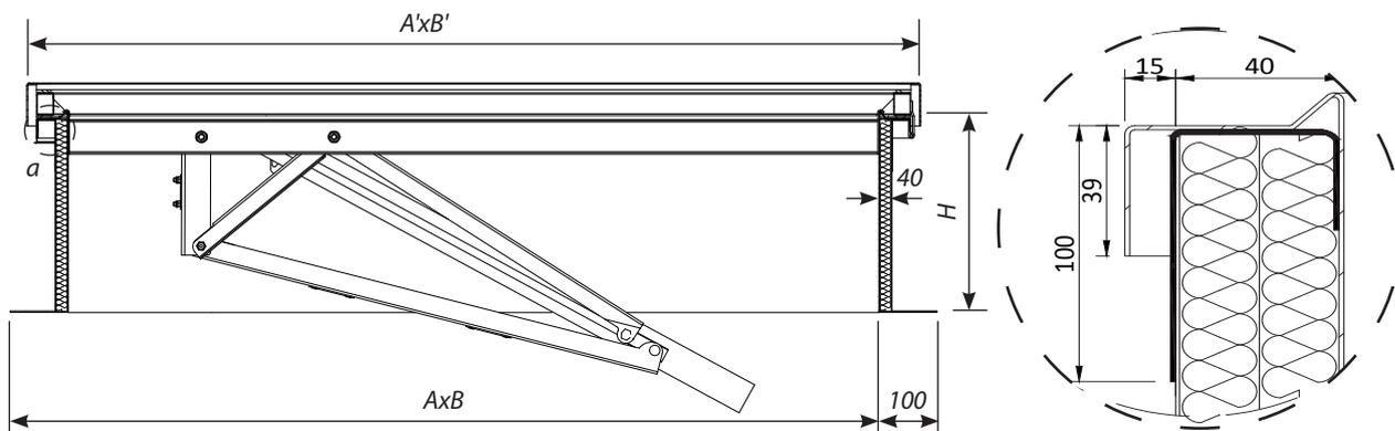
Люк дымоудаления типов C/E в разрезе В-В в закрытом положении, размеры в [мм]
