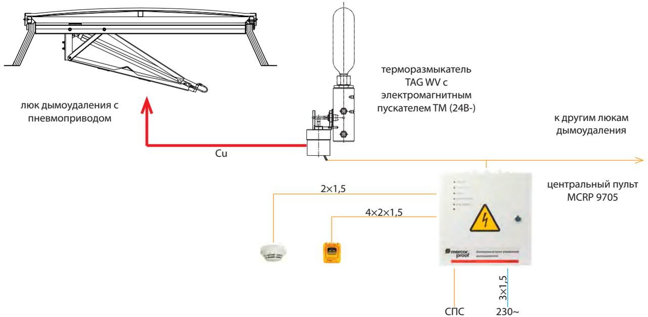
**Пневматическая система управления люками для дымоудаления с автоматическим открыванием от терморазмыкателей и дистанционным (ручным) открыванием с пневматического пульта пожарной тревоги, а также дистанционным (автоматическим) открыванием от электрического сигнала 24В-**
