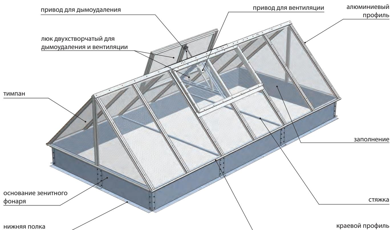
Конструкция треугольной световой полосы с люками, оснащенными пневмоприводом для дымоудаления и электроприводом для вентиляции
