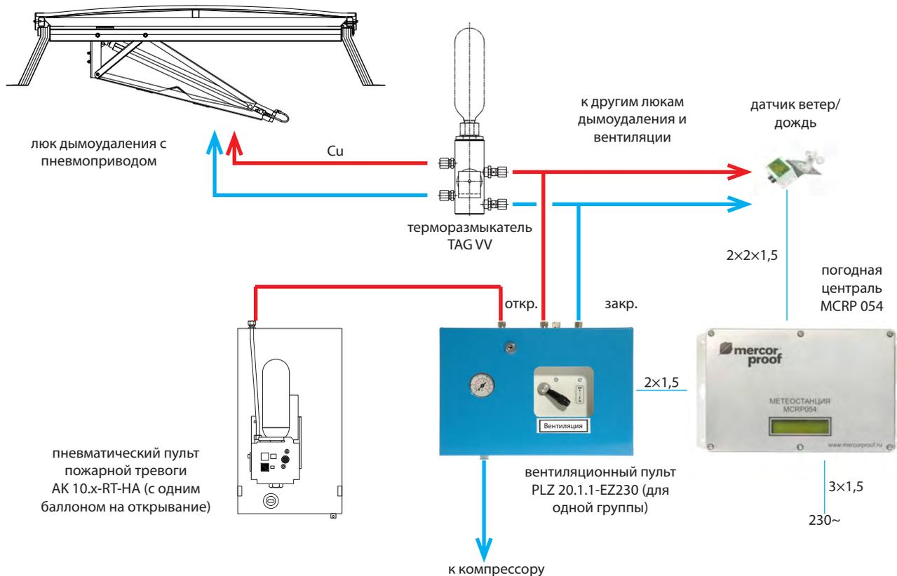
Пневматическая система управления люками для дымоудаления и вентиляции с автоматическим открыванием от терморазмыкателей и дистанционным (ручным) открыванием и закрыванием с пневматического пульта пожарной тревоги, а также с электрическим приводом для вентиляции 230В
