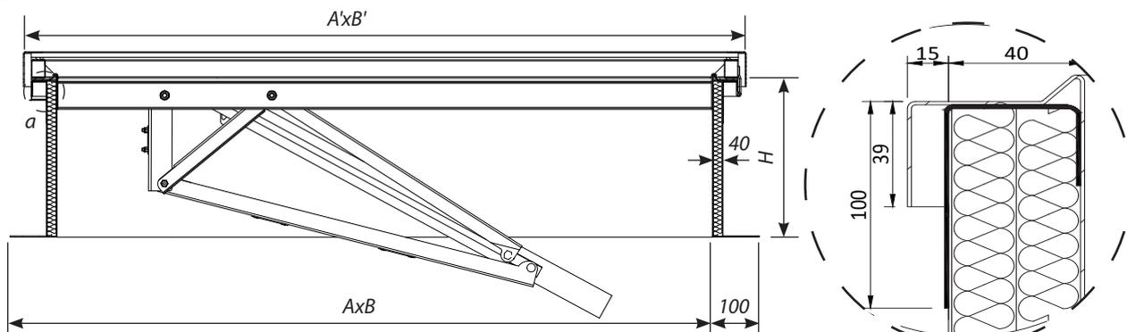
Люк дымоудаления типов C/E в разрезе В-В в закрытом положении, размеры в [мм]
