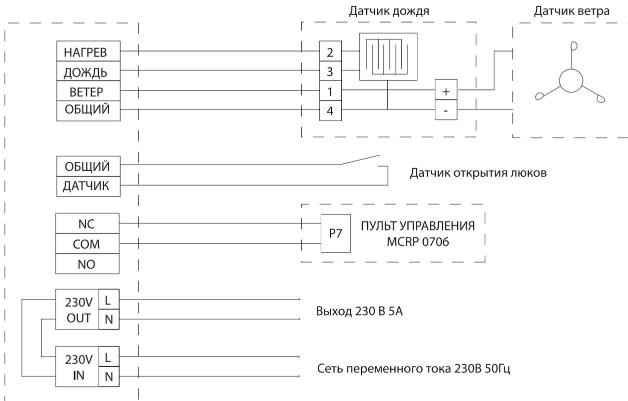
**5.1.15.** Управление вентиляционными приводами 230V~ - система без погодной автоматики
