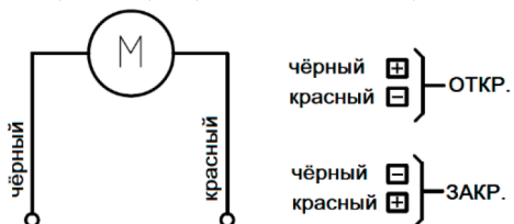
Рисунок 12. Пример схемы подключения привода mcr V
